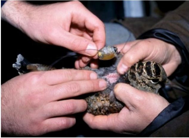
Fig. II.1 : l'émetteur est collé sur le dos de l'oiseau, sur une zone de peau nue existant naturellement (photo du haut). Ensuite, les deux fils du harnais sont passés derrière les ailes et devant les pattes, pour former une ceinture, et certis dans un tube de plomb à l'aide d'une pince (photos du milieu). L'émetteur se trouve vers le centre de gravité de l'oiseau et l'antenne est légèrement surélevée (photo du bas).
